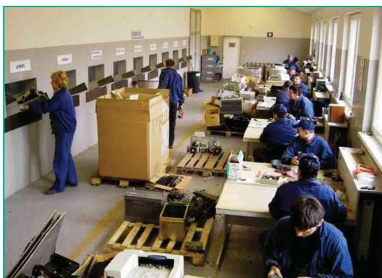
Dielňa na demontáž elektrozariadení
